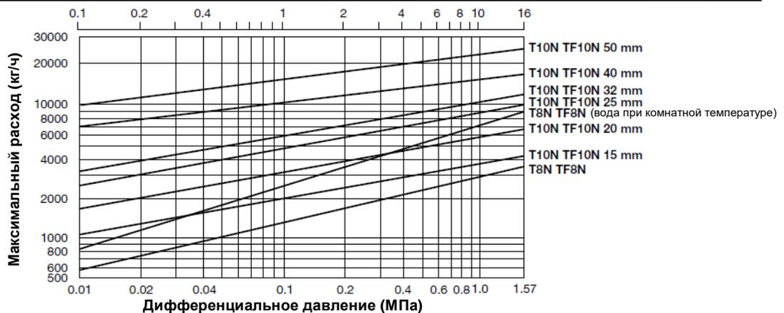
1. Характеристики соответствуют непрерывному расходу конденсата с температурой на 6°C ниже температуры насыщения (или расходу воды с комнатной температуры, если это указано).
